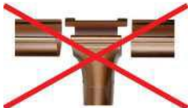
Kotlík mezi dvěma žlaby (špatně)
