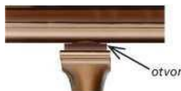
kotlík průběžně na žlabu s vyříznutým otvorem (správně)
