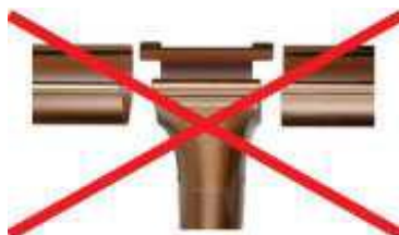
kotlík na konci žlabu (špatně)
